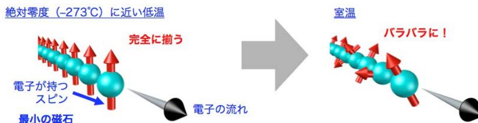
図1 電流と電子のスピンとの関係。低温ではスピンの向きは完全にそろっている。室温ではスピンの向きがバラバラになっている。
