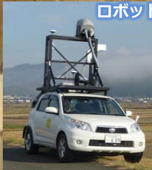
堤防形状3次元計測車による点検
