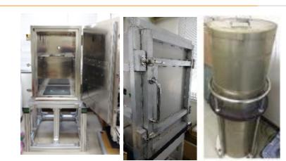
磁気シールドボックス Magnetic shielding box 3 sets
