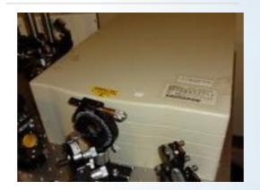
チタンサファイアレーザー Ti:Saphire laser 2 sets
