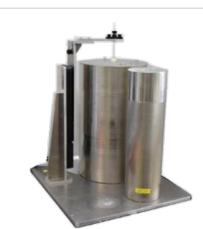
磁気免疫計測装置 Magnetic immunoassay system
